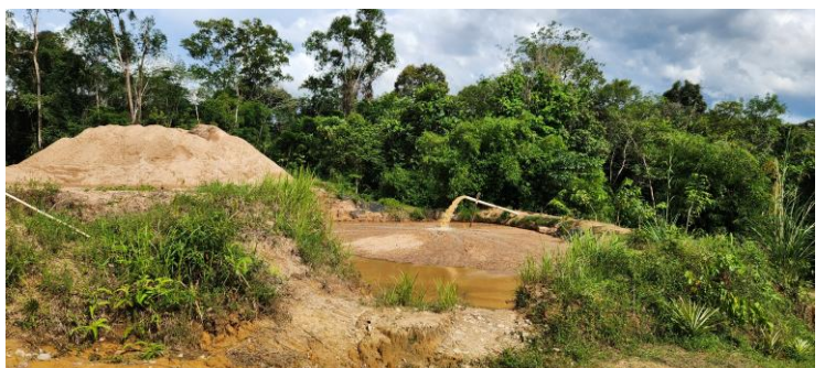
Op één locatie wordt rivierzand opgehoopt dat vervolgens naar onze betonfabriek wordt vervoerd, waar samen met grind en cement het beton wordt gemaakt voor onze verschillende projecten.
